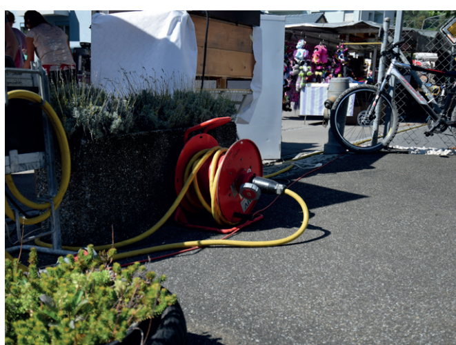
Kabelrolle mit Traggestell aus Stahlrohr
